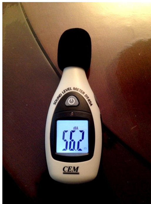
Figura 13 - Decibelímetro marca CEM utilizado para aferição de ruído.
